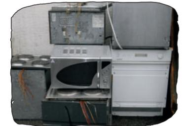
ganz allgemein Großgeräte mit Antriebsmotor(en) können größere PCB<sup>5</sup>-haltige Kondensatoren beinhalten. Das betrifft auch kleinere Kondensatoren z.B. in Vorschaltgeräten in Leuchtstofflampenleuchten die bis etwa 1983 hergestellt wurden. Es kann noch sein, dass PCB-haltige Kondensatoren aus einzelnen Ostblockländern noch bis ca. 1986 in Verkehr gebracht wurden, weshalb Kondensatoren aus den Elektrogroßgeräten zu entfernen sind, wenn dies ohne größeren Aufwand möglich ist.
